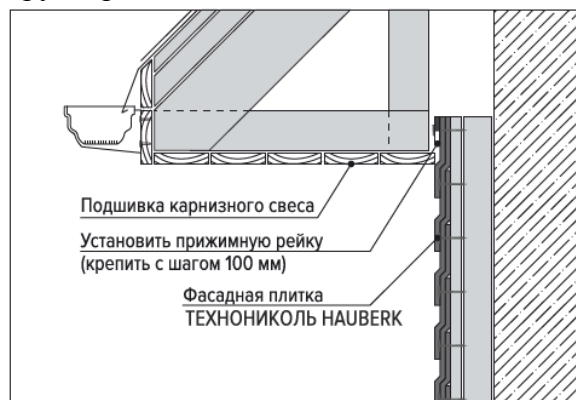
Рис.9.1 Монтаж верхнего ряда под карнизным свесом. Вариант 1
