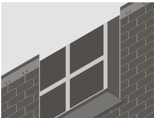
Рис.8.2 Установка подоконного отлива
