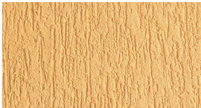
Штукатурка Ceresit СТ 35, зерно 3,5 мм, получена путем затираний пластиковым полутерком (теркой) в одном направлении
