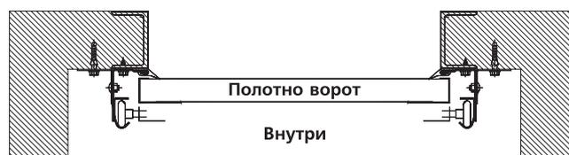
При невозможности установки металлического обрамления проема крепление ворот следует производить при помощи стяжных шпилек.
