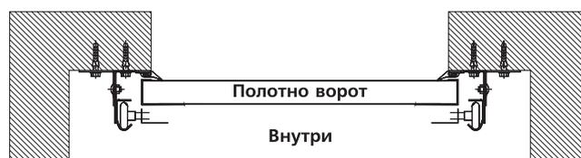
При выполнении несущих строительных конструкций из пустотелых материалов, таких как эффективный кирпич (пустотный керамический и силикатный кирпич) или камни керамические щелевые и камни силикатные, а также из ячеистых бетонов (газо- и пенобетон, газо- и пеносиликат) и газосиликатных блоков рекомендуется проем оформлять конструкцией из металлического фасонного профиля.
