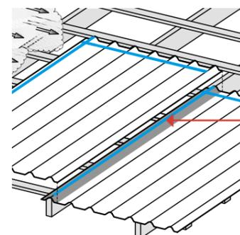
При монтаже на уклоне крыши 5-15° в местах горизонтального и вертикального нахлестов по линии точек крепления обязательное использование ленты ОНДУТИС ВЛ.
